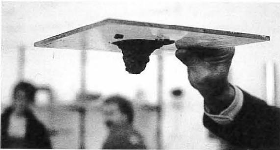
Bild 5: Erhöhte Haftung eines Mörtels bei Microsilicazusatz ermöglicht auch den Auftrag von Spritzbeton über Kopf ohne Zugabe von Erstarungsbeschleuniger
