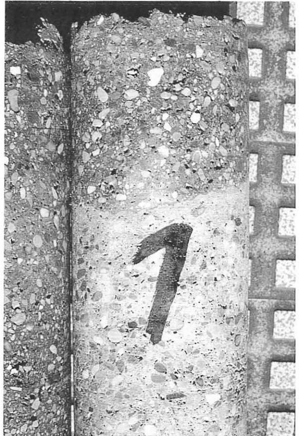
Bild 3: Bohrkern aus Vorversuchen für die einschalige Spritzbetonbauweise. Deutlich ist die verschmutzte Oberfläche des Sicherungsspritzbetons zu erkennen, die nicht mit Hochdruckwasserstrahl gereinigt war.
