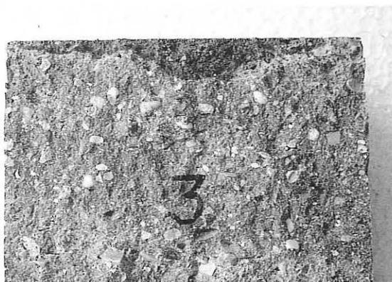
*Bild 9: Wassereindringtiefe an einem Spritzbeton-Bohrkern nach Wasserundurchlässigkeitsprüfung*
