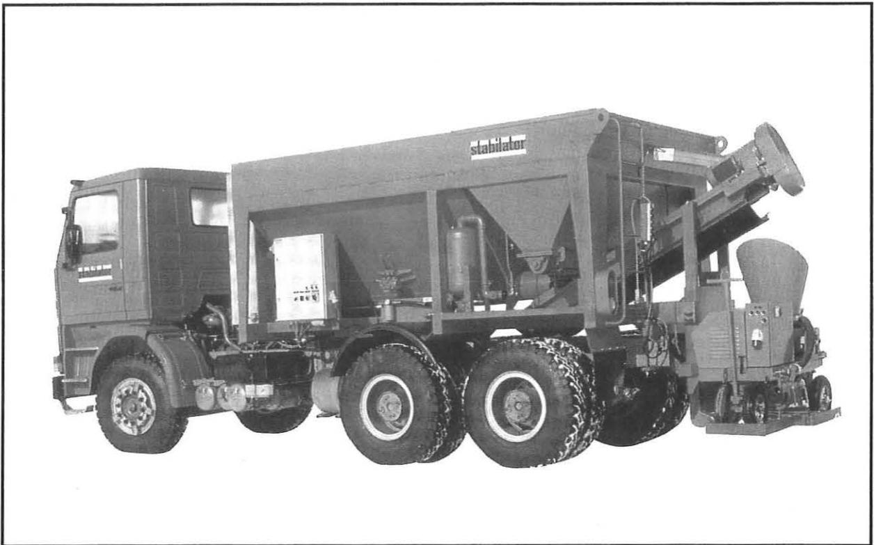
*Bild 1: Trixer B 8400, Zementvorrat 2,2 m<sup>3</sup>, Zuschlagvorrat 6,2 m<sup>3</sup>, Beschleunigervorrat 0,9 m<sup>3</sup>, maximale Mischleistung 19 m<sup>3</sup>/h, Strombedarf 14,0 kW.*
