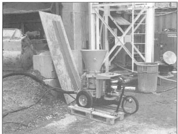
Bild 14: Spritztest Einspritzen Fugenbänder
