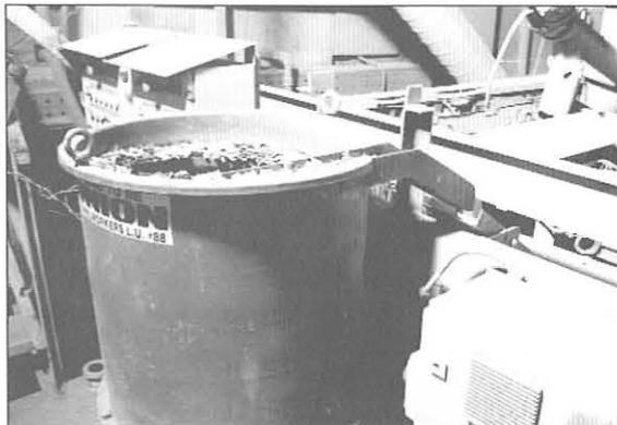
Bild 9: Stahlfaserdosieranlage neben Steuerpult der Spritzanlage
