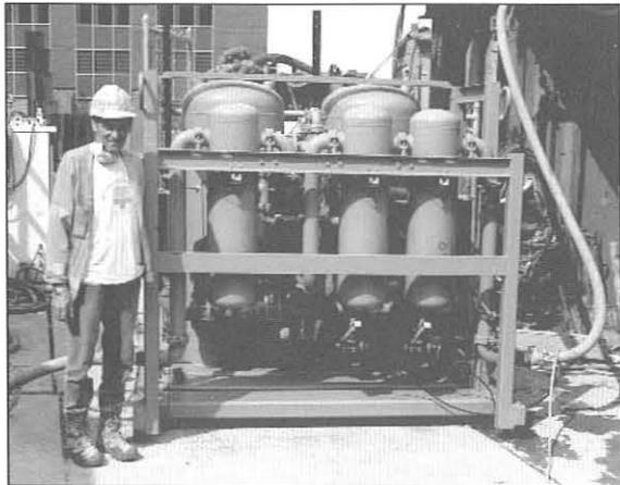
Bild 11: Luftentfeuchter Förderluft
