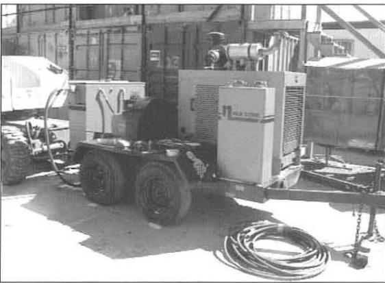
Bild 17: Hochdruck-Dampfstrahler zur Vorbereitung des Untergrundes für die 50 mm Deckschicht
