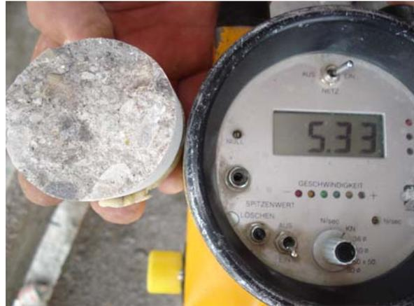
*Bild 14: Haftzugfestigkeit, 100 % Bruch im Beton*
