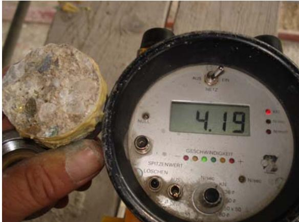
*Bild 9: Oberflächenzugfestigkeit nach dem HDW-Strahlen*
