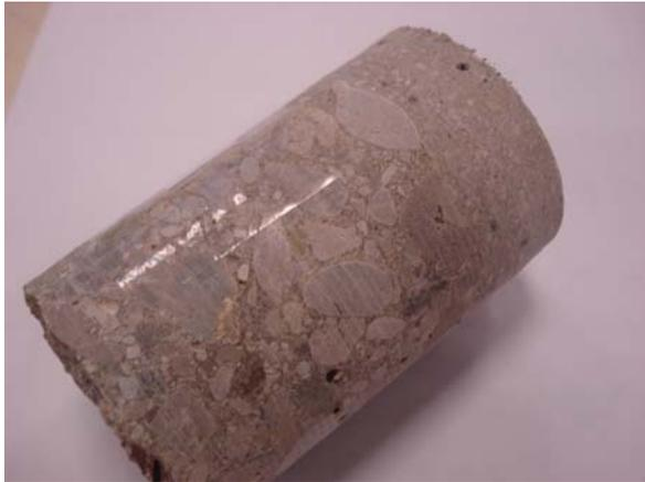
*Bild 13: Bohrkern zeigt gute Verdichtung und einwandfreien Verbund des SPCC zum Untergrund*
