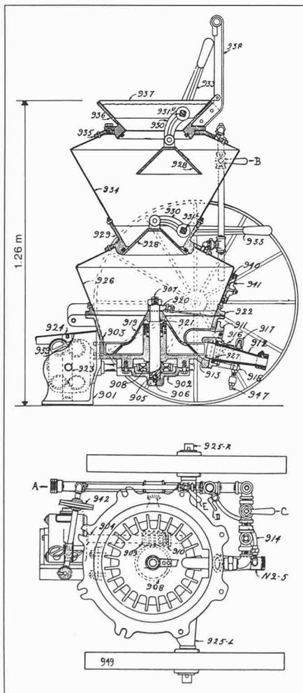
Bild 6. Cement-Gun, Typ N (aus: «The Cement-Gun», 1914)
