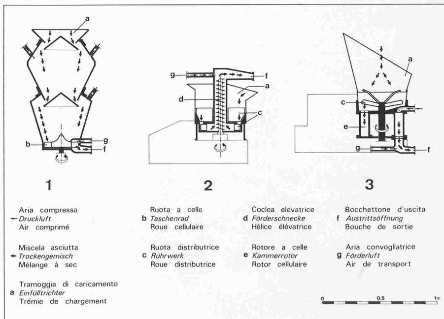
Bild 9. Funktionsweisen von Zweikammermaschine (1), Schneckenmaschine (2) und Rotormaschine (3)
