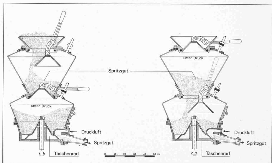
Bild 3. Funktionsweise der Zweikammermaschine (Cement-Gun, Typ N)
