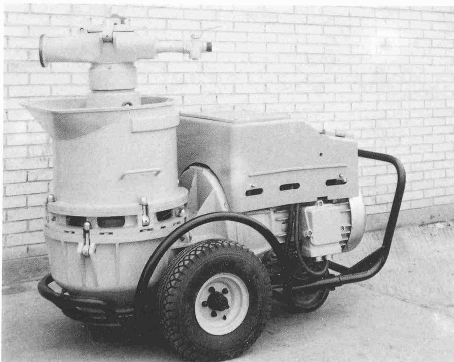
Bild 11. Schneckenmaschine BS-12 (Werkaufnahme Spribag AG)
