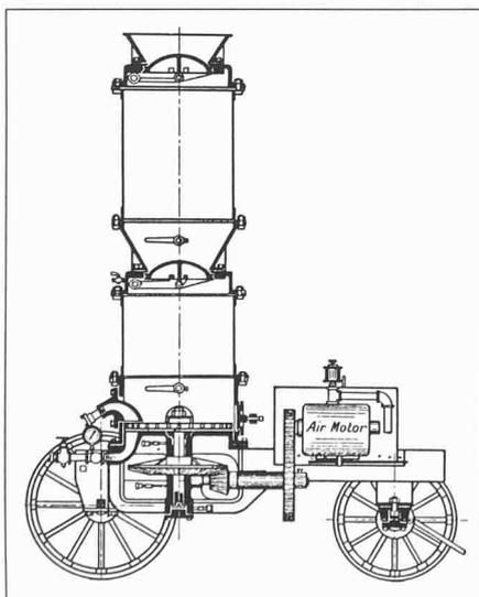
Bild 4. Schnitzzeichnung des ersten Modells der Cement-Gun, 1910 (aus: «The Cement-Gun, Guniting and their uses», The Engineer, 1912)
