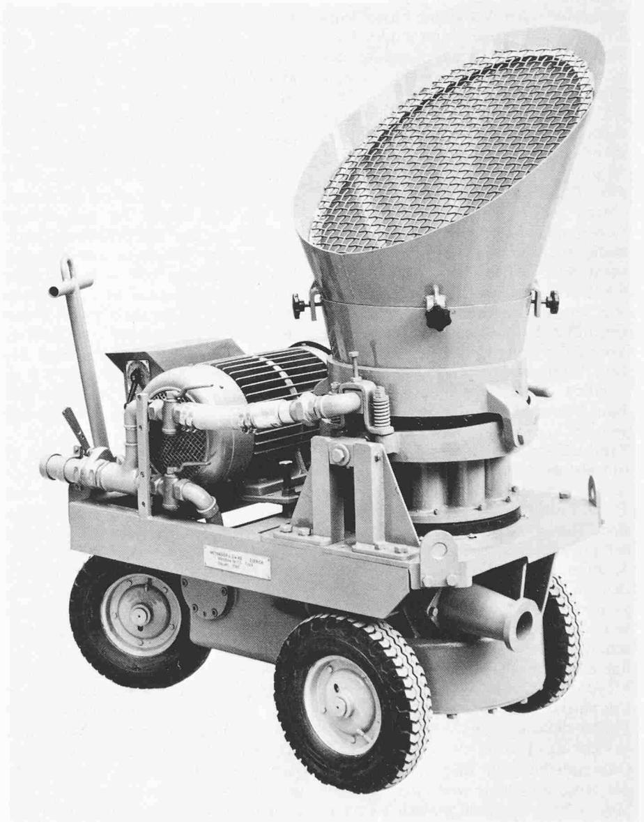
Bild 12. Rotormaschine Meyco GM 57 (Werkaufnahme Meynadier & Cie. AG)
