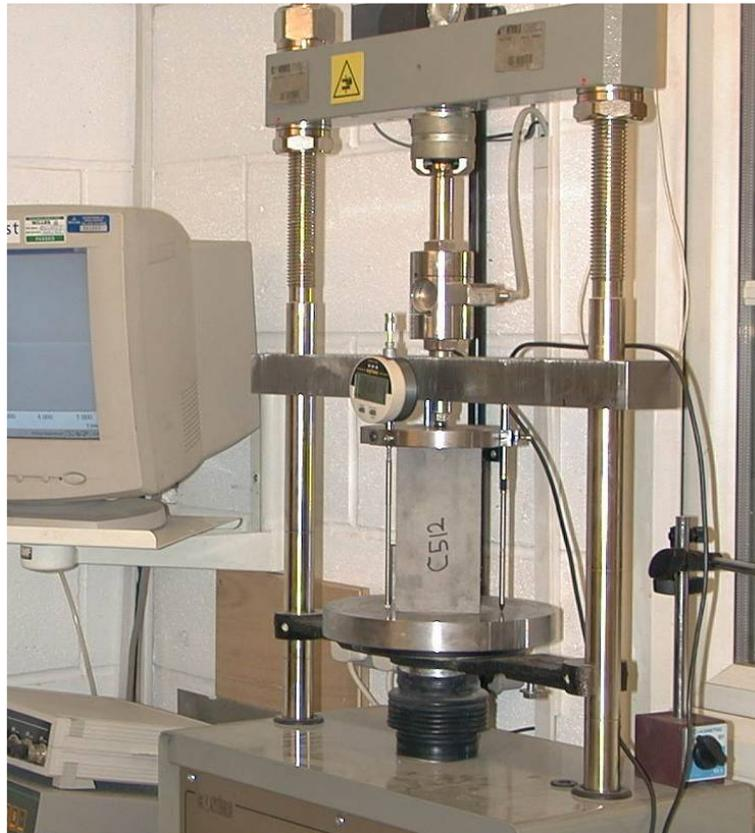
*Bild 41: Test der "Jungen" LaserShell-Mischung*
