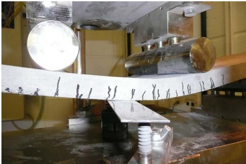
*Bild 44: Biegezugversuch eines HPFRCC-Testkörpers*
