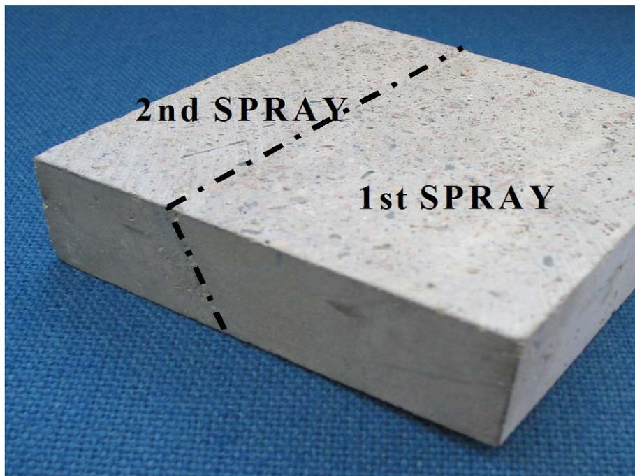
*Bild 40: Schnitt durch einen zweilagig gespritzten Biegebalken*
