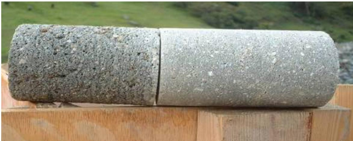
*Bild 1: Beide Spritzbetonproben stammen aus dem gleichen Arbeitsbereich. Sowohl die Ausgangsmischung als auch die Qualitätsvorgaben waren für beide Proben identisch. Der Spritzbetoneinbau erfolgte in beiden Fällen mit demselben Spritzroboter, aber mit verschiedenen Düsenführern. Welchen der beiden Düsenführer würden Sie wohl für Ihr Tunnelprojekt wählen?*
