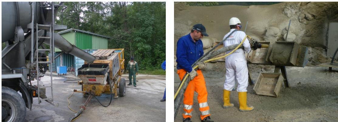
*Bild 2: Spritzversuch mit TBA-Beton am Spritzstand (Foto: Schretter & Cie)*
