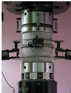
Bild 5: Eingespannte Probe mit Messinstrumenten (Foto: Galler) [3]
