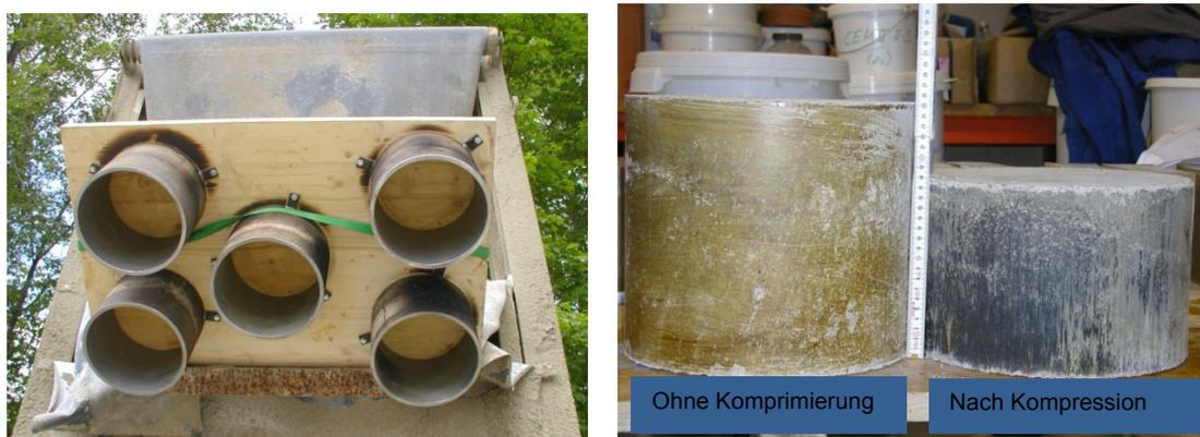
*Bild 3: Schalung und Probekörper für die Prüfung der Komprimierbarkeit (Foto: Schretter & Cie)*
