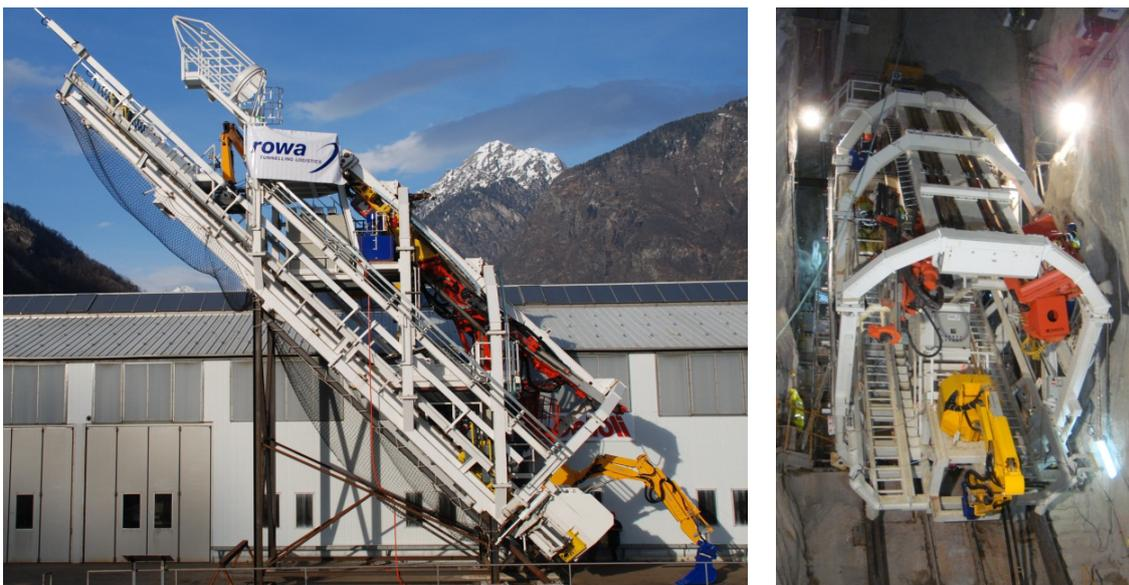
*Bild 17: Vortriebsinstallation mit integrierten Geräten und Installationen für den fallenden Sprengvortrieb La Muela II.*
