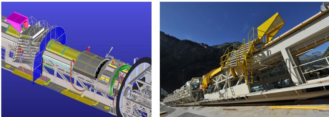
*Bild 9: Netzeinbaubühne und zwei Spritzbetonmanipulatoren auf dem längs verfahrbaren Chassis.*
