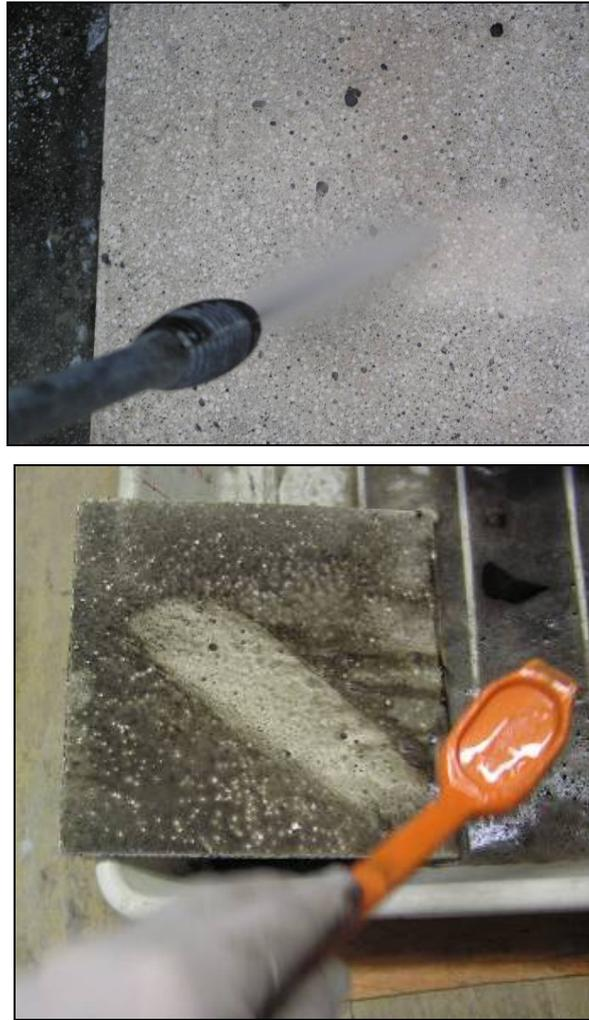
*Bilder 8: Reinigung der Probekörper (Fotos VÖZfi)*
