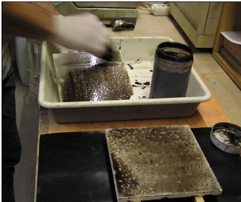
*Bild 7: Herstellung der künstlichen Verschmutzung (Foto VÖZfi)*
