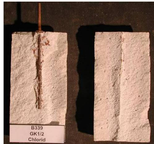
*Bild 6: Prüfanordnung und Prüfkörper nach Prüfungsdurchführung (Foto VÖZfi)*
