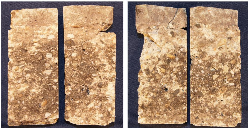
Bild 5: Visualisierung der Chloridbelastung mit Silbernitratlösung
