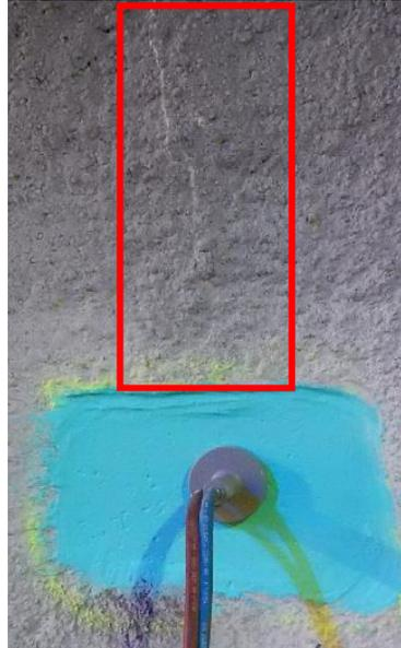
*Bild 6: Versuch mit der Vakuumzelle an einem mit Mapelastic TU vorbehandeltem Riss (Bild: BeMo-Tunnelling)*
