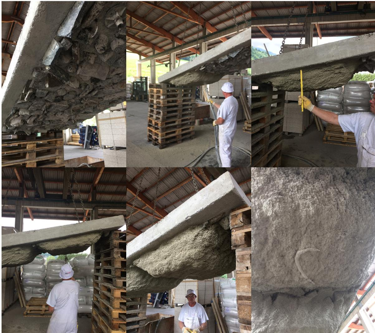
*Bild 9: Bilderserie des Spritzversuches in Wattens (Bilder Schretter & Cie).*
