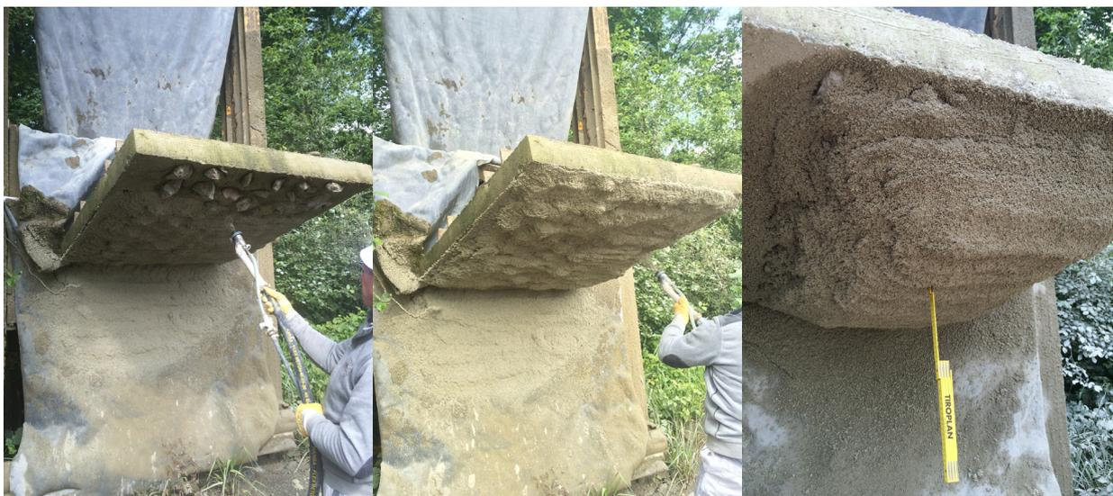
Bild 7: Bildserie des Spritzversuches in Vils (Bilder Schretter & Cie)
