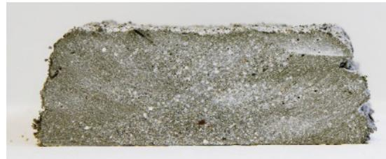
Bild 17: 3-lagige Bahn, 2 Bar, 15 cm, Querschnitt (Bild: ITE)
