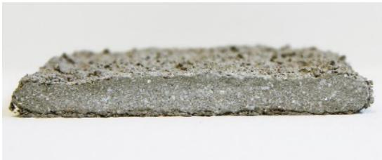
Bild 16: 1-lagige Bahn, 2 Bar, 15 cm, Querschnitt (Bild: ITE)
