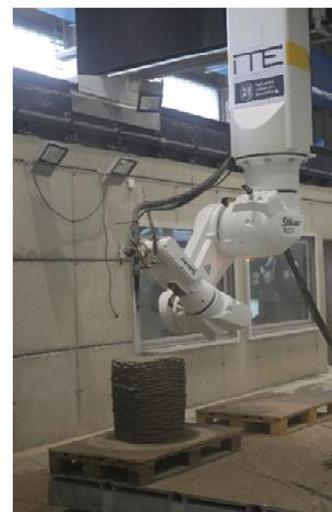
*Bild 9: Vertikaler Spritzprozess, Roboter an Kranportal, DBFL (Bild: ITE)*
