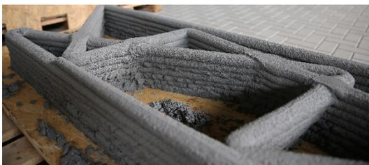
*Bild 6: Vorversuch Beton Extrudieren, Detail, DBFL (Bild: ITE)*
