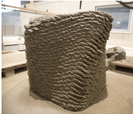
Bild 21: Über die Z-Achse verdrehte Stütze mit Überhang (Bild: ITE)
