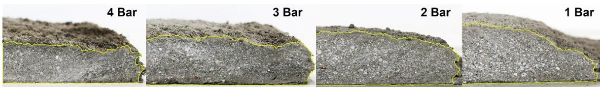
*Bild 18: Bahngeometrie in Abhängigkeit vom Luftdruck. Düsenabstand konstant bei 20 cm. (Bild: ITE)*
