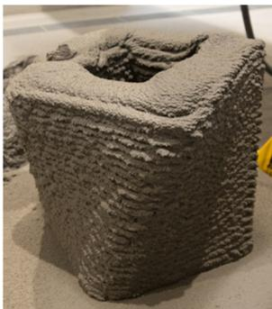
*Bild 2: Vom DBFL mittels Spritzverfahren hergestellte Struktur mit Überhang (Bild: ITE)*
