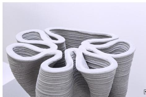
*Bild 1: Charakteristische Oberflächen additiv gefertigter Strukturen – links: mittels Pulverbetttechnik (Bild: TU München); rechts: mittels Extrusion (Bild: XtreeE – Osman M. Gyasi)*
