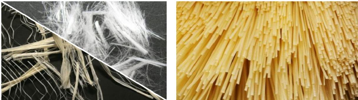
*Bild 4: Vergleich Mikrofaser (links) zu Makrofaser (rechts)*
