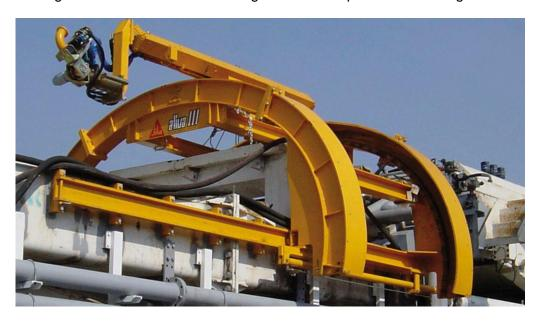
Bild 3: Spritzbetonmanipulator auf elliptischem Bogen, Fa. Sika – Aliva, [6]
