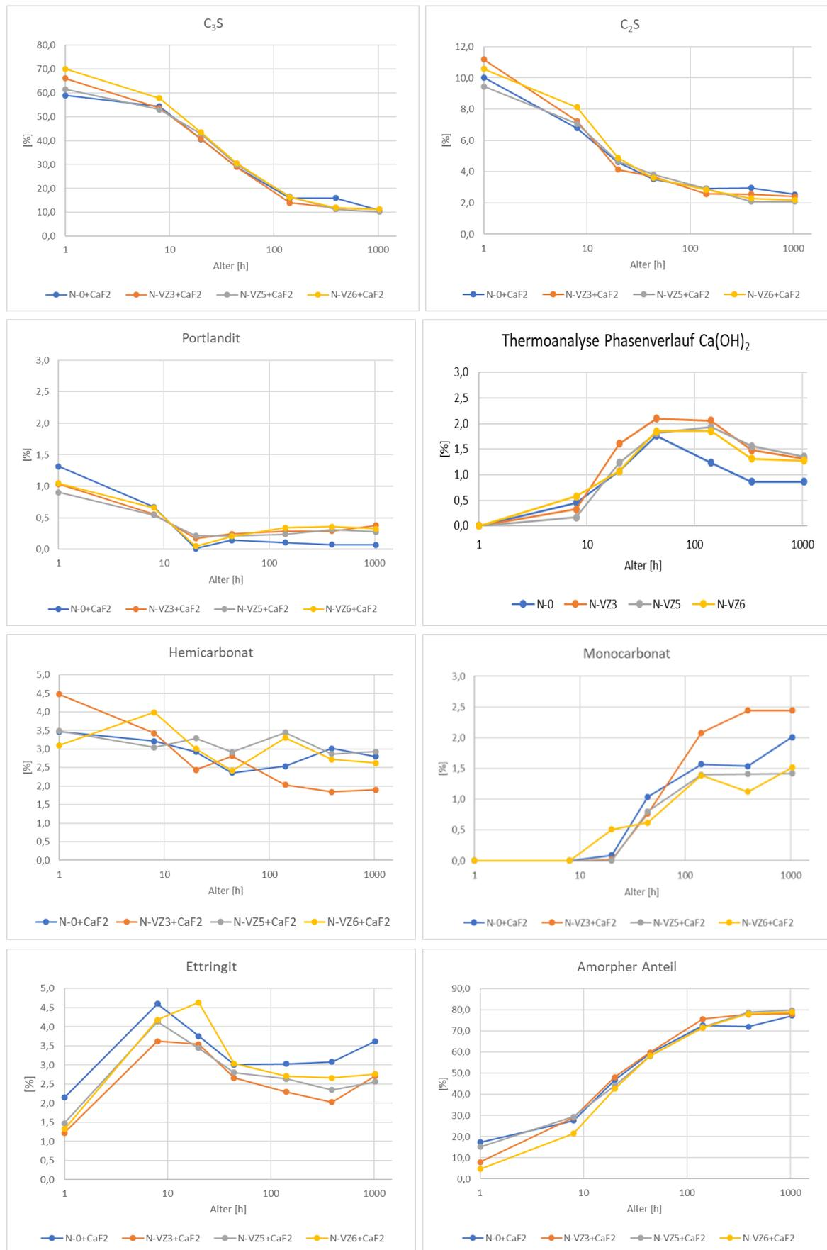
Bild 10: Phasenentwicklung an beschleunigtem Zementleim mit und ohne Verzögerer.
